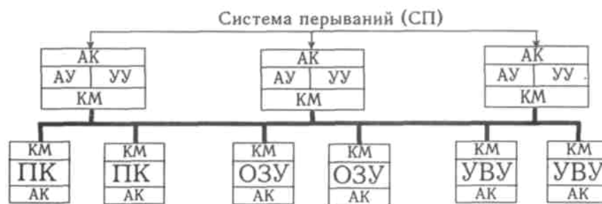
Рис.9. Система резервирования на уровне модулей устройств возимой ЭВМ 5Э26 АУ - арифметическое устройство, УУ - устройство управления, АК - пооперационный аппаратный контроль, КМ - разнесенный (по модулям) центральный коммутатор, ПК - неразрушаемая память команд, УВУ - устройство управления внешними устройствами, ОЗУ - оперативное запоминающее устройство.
