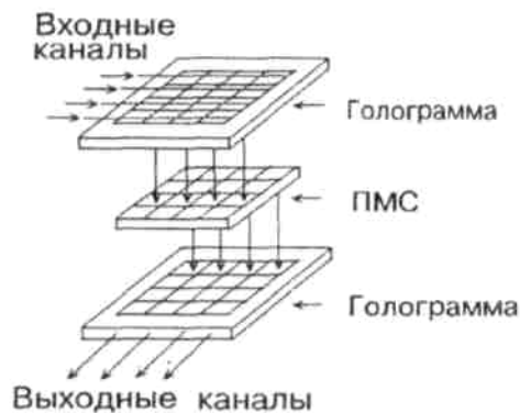
Рис.14. Интегральная реализация матричного коммутатора.
