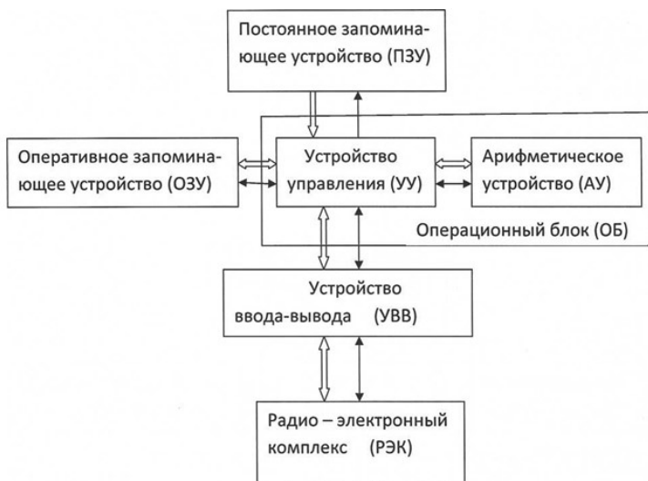
Рис. 2.1.1. Блок-схема БЭВМ «Гном» радиоэлектронный
