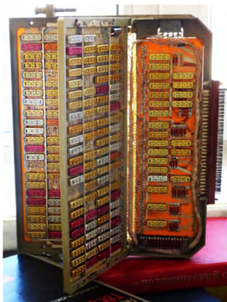
Рис. 2.5.1. Групповой модуль (МГ) операционного блока «Гном-А»
