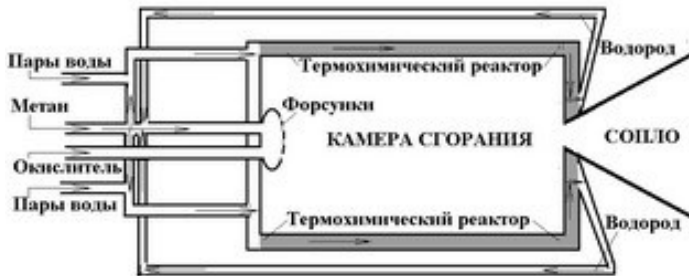
Рис. 3.4.3. Пример камеры сгорания с активным тепловым охлаждением
