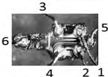
Рис. 1.3.3. ТС P12-2 (ТС-233) с объёмным сопротивлением
