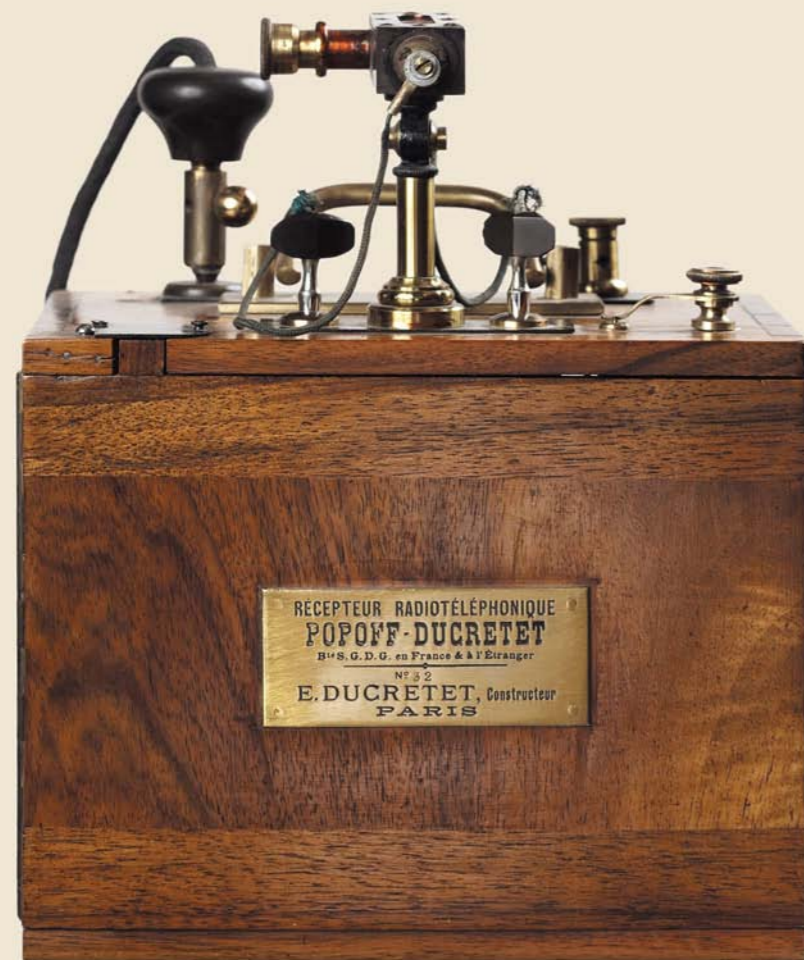
Детекторный приемник с телефоном для приема телеграмм на слух системы Попова. Франция, фирма «Дюкрете», 1901 г.
