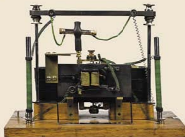
Когерентный приемник А.С. Попова. 1899 г.
