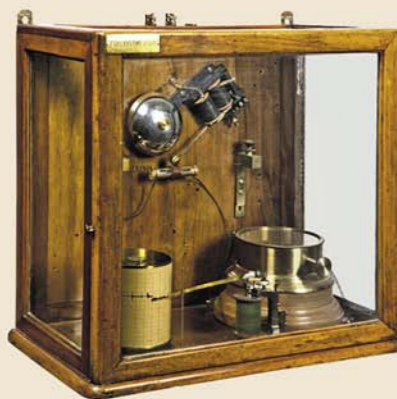
Прибор для обнаружения и регистрирования электрических колебаний в атмосфере (грозоотметчик) А.С. Попова. 1895 г.
