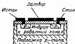
Рис. 6-40. Структура полевого МОП-транзистора.
