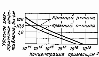
Рис. 6-5. Зависимость удельного электрического сопротивления кремния от концентрации примесей.
