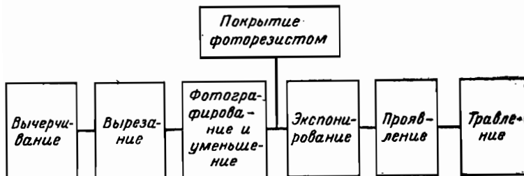
Рис. 4-17. Этапы изготовления печатной платы.
