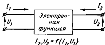
Рис. 2-8. Представление схемы в виде четырехполюсника.
