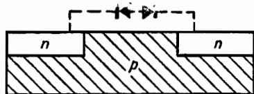
Рис. 6-36. Изоляция с помощью p - n перехода.
