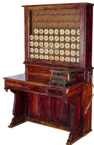
Рис. 3. Табулятор Холлерита (Политехнический музей) [35]
