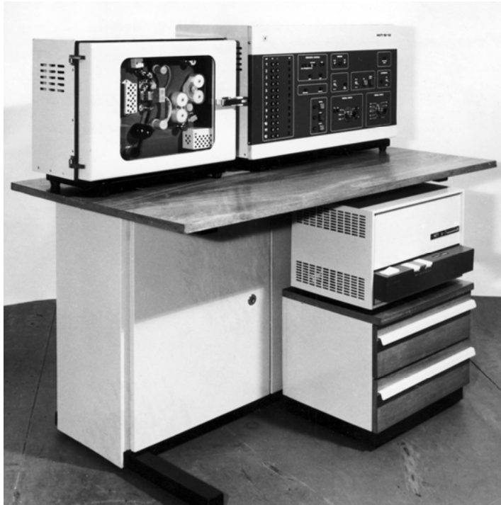
Аппаратура контроля магнитной ленты АКЛ-12-1.8
