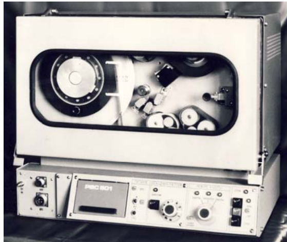
Устройство снаряжения кассет и очистки МЛ
