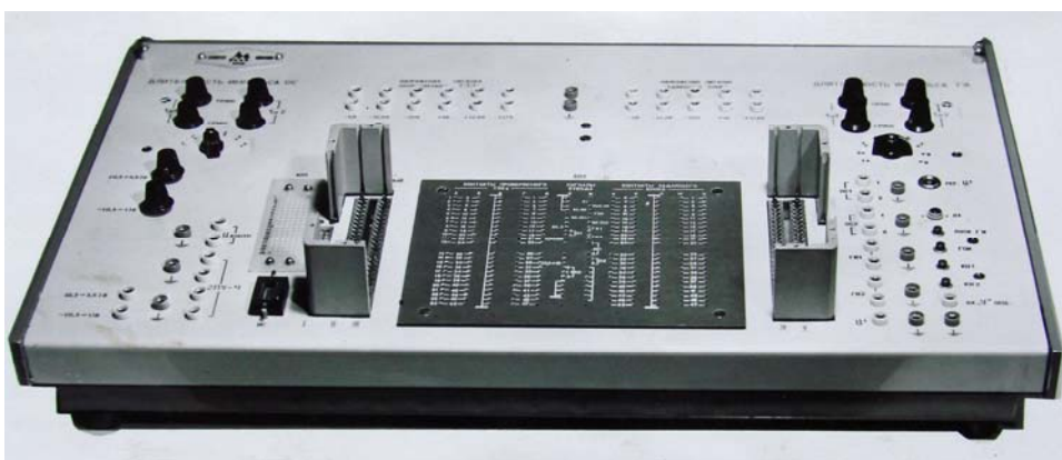
Стенд проверки специальных ТЭЗов ЕС А104
