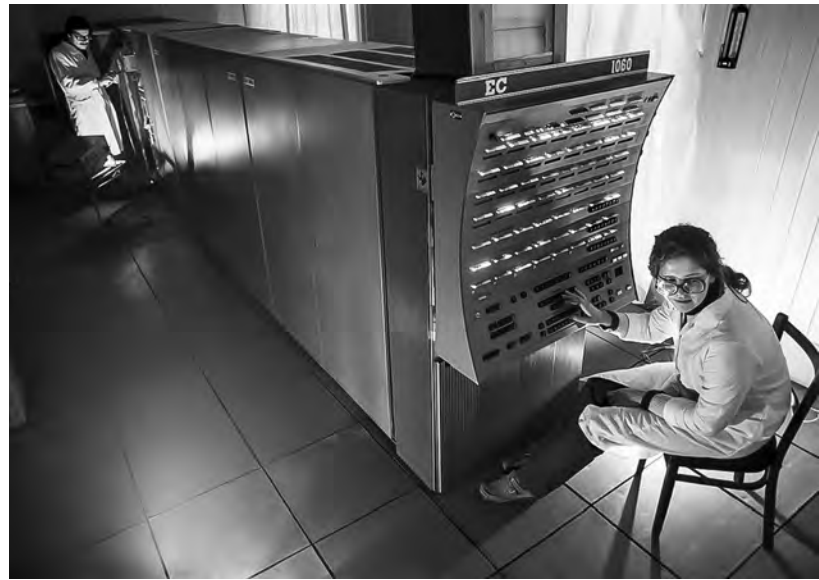
В Вычислительном центре АН СССР, 1983 г. Инженеры проводят тестовую проверку памяти ЭВМ ЕС-1060
