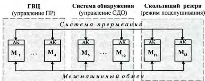
Рис.4. Система сквозного резервирования на уровне машин. М1 —М12 — универсальные ЭВМ 5Э926, АК — система аппаратного контроля
