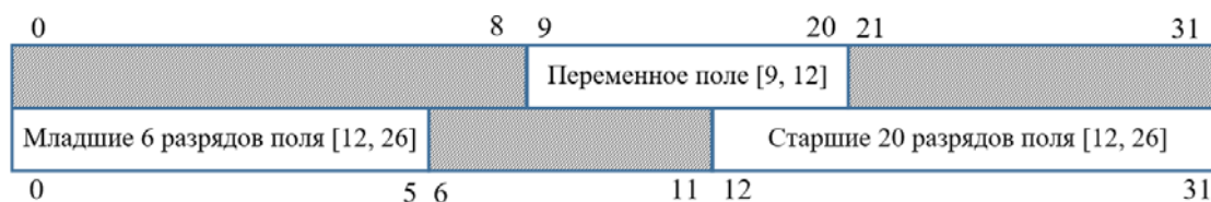
Рис. 8. Размещение переменных полей в памяти ЭВМ
