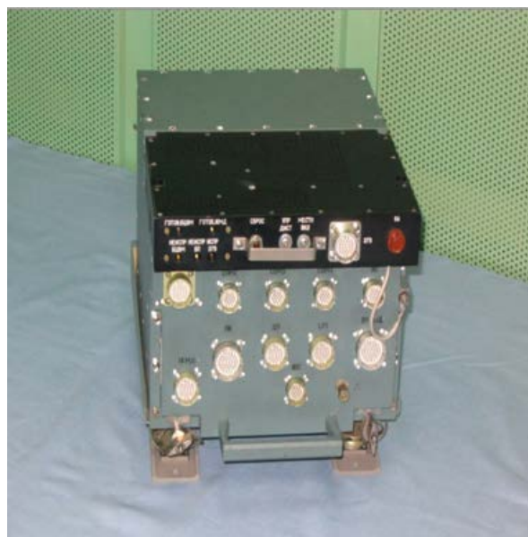
Рис. 3. Базовое изделие бортового вычислителя EA2170
