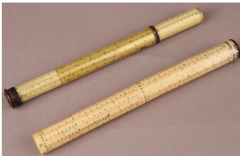
Рис. 4. Счётная цилиндрическая линейка системы профессора М.Е. Подтягина
