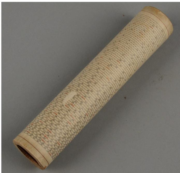
Рис. 2. Счетный логарифмический цилиндр системы профессора А.Н. Щукарёва
