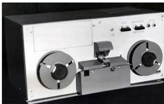
Рис. 12. Фотосчитывающий механизм ФСМ-8
