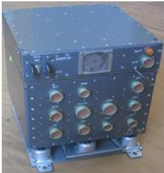
Рис. 5. Двухпроцессорный бортовой вычислитель. Базовое изделие EA2171
