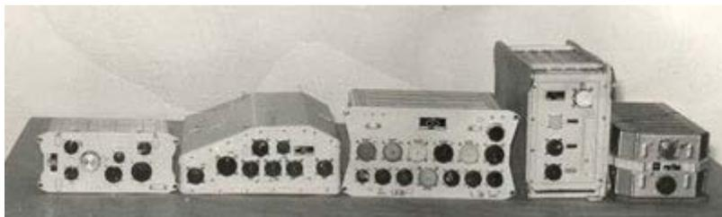
Рис. 5. Управляющая цифровая вычислительная машина «Кальмар»
