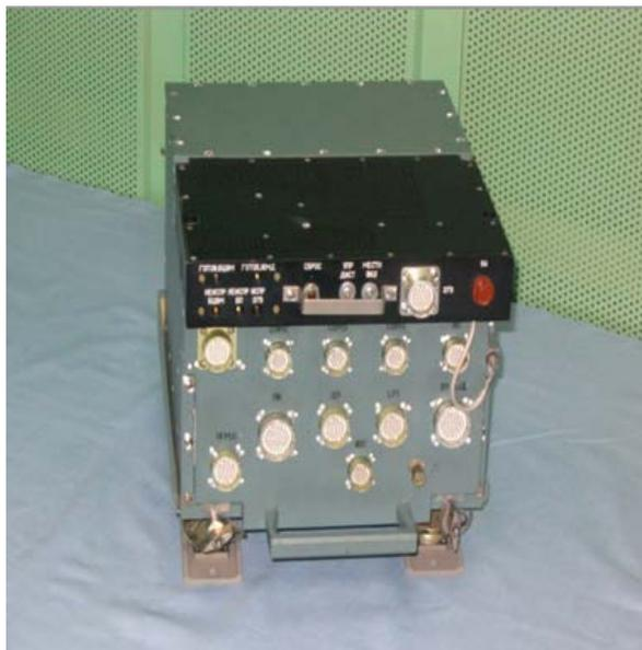
Рис. 3. Базовое изделие бортового вычислителя EA2170
