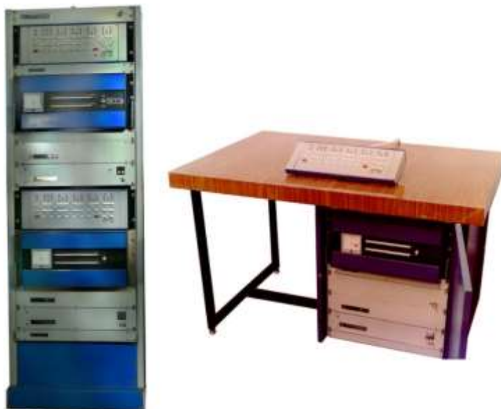
Рис.76. Стойка МКТК «Электроника НЦ-32» и его абонентский пункт
