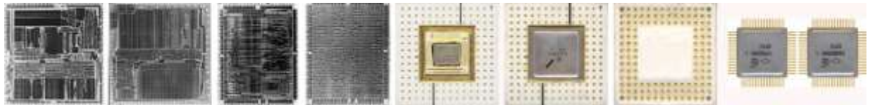
Рис. 89. Топологии кристаллов и корпуса БИС серии Л1839
