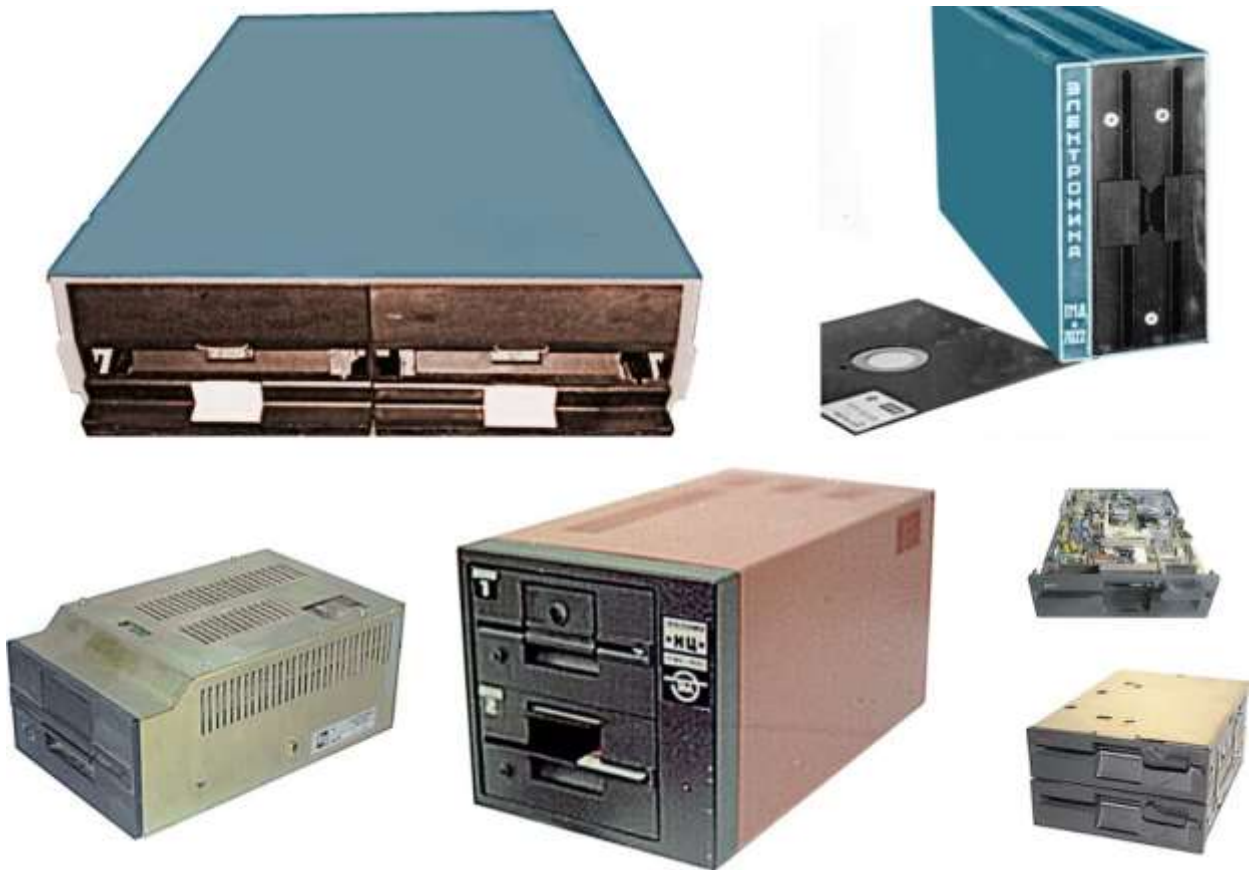
Рис. 105. Примеры 8- и 5,25-дюймовых НГМД (дискетоды) МЭП
