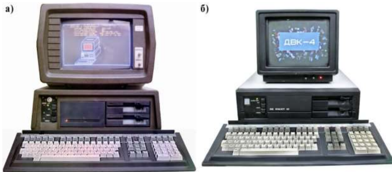
Рис. 99. ДВК-4 - в моноблоке (а) и с системным блоком (б)
