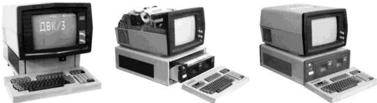
Рис. 98. Варианты унифицированного моноблока ДВК-3 (в центре – с встроенным сверху открытым принтером)
