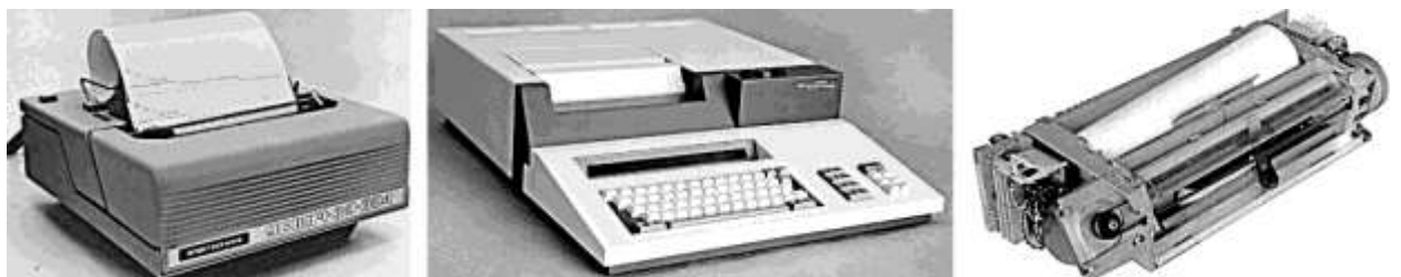
Рис. 108. Примеры принтеров МЭП, справа – встраиваемый термопринтер для ДВК-3/4
