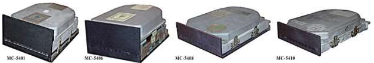
Рис. 106. Примеры 5,25-дюймовых НЖМД (винчестеры) МЭП
