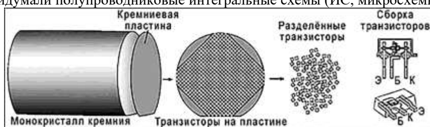
Рис. 3. Групповое изготовление транзисторов
