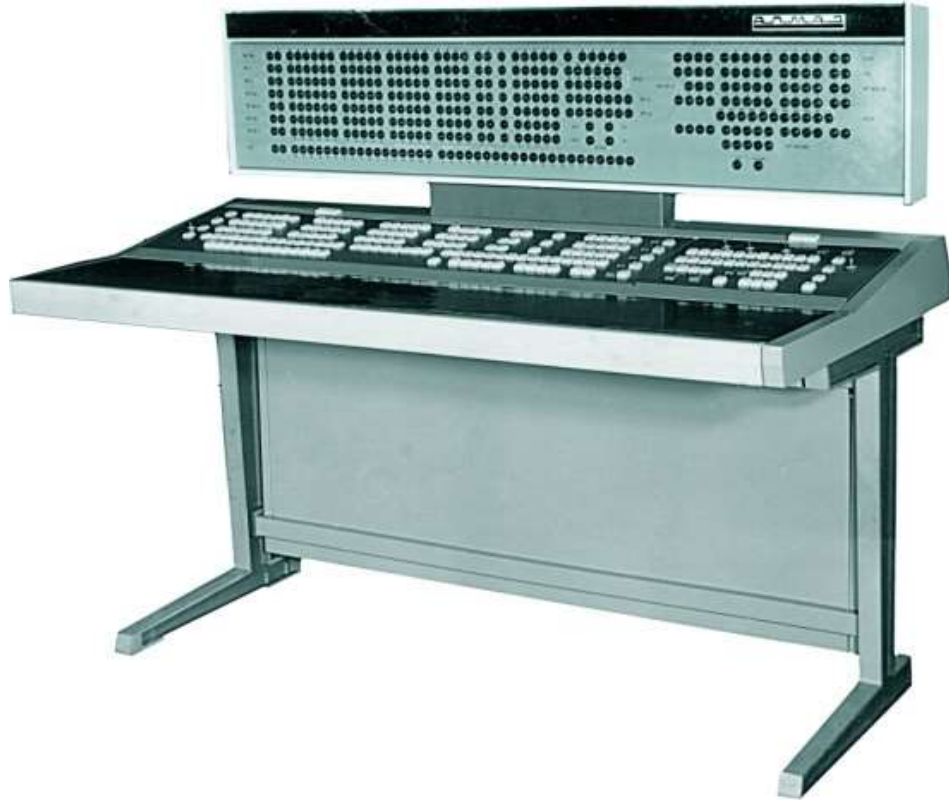
Рис. 45. Инженерный пульт управления ЭВМ Алмаз
