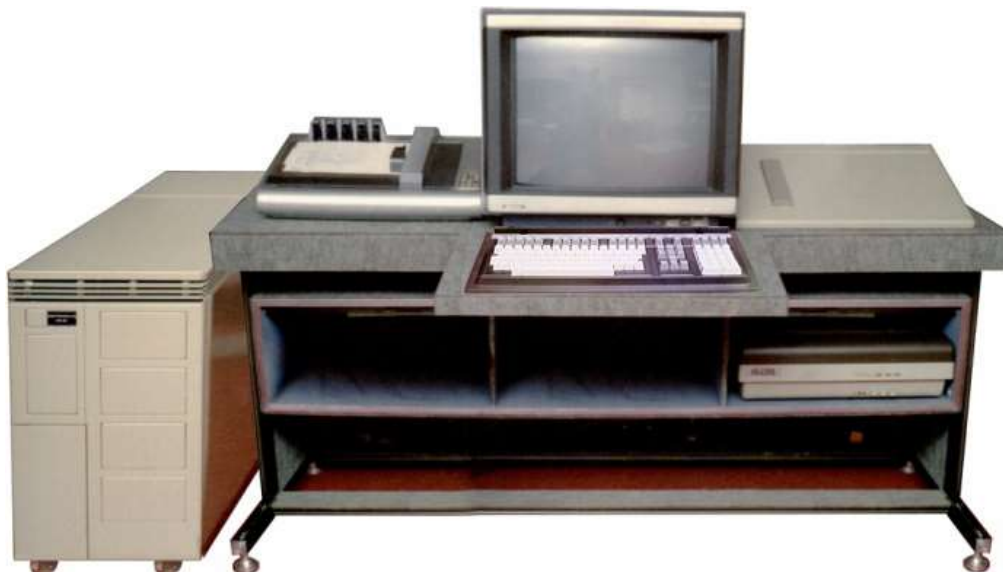
Рис. 118. «Электроника НЦ-ИРС-32» с графопостроителем (слева), дигитайзером (справа) и принтером (в столе)
