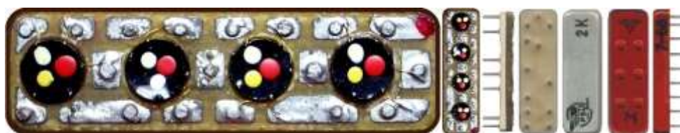
Рис. 14. Модули Квант вскрытые и в сборе
