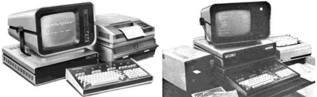
Рис. 97. ДВК-2 с 8-дюймовым НГМД и термопринтером и ДВК-2М с 5-дюймовым НГМД и матричным принтером, всё производства МЭП
