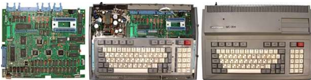
Рис. 103. Школьная ЭВМ «Электроника УК-НЦ» (МС 0511): плата, внутреннее устройство, внешний вид
