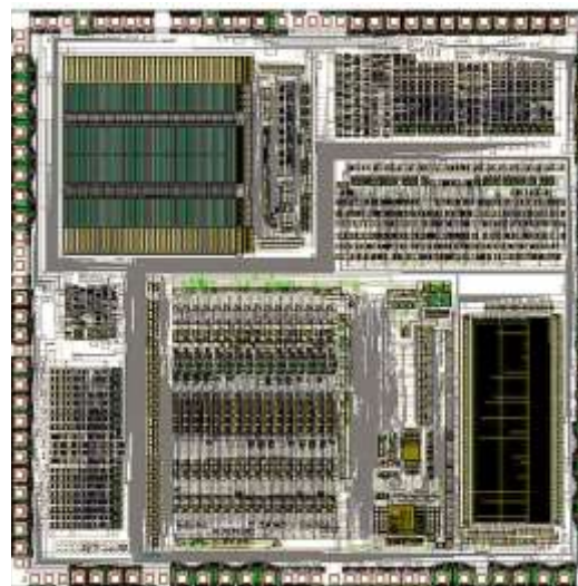
Рис. 127. Л1875ВЕ1 – 2-й вариант фрагментно-модульного микроконтроллера ЛКТБ "Светлана", 1987 г.
